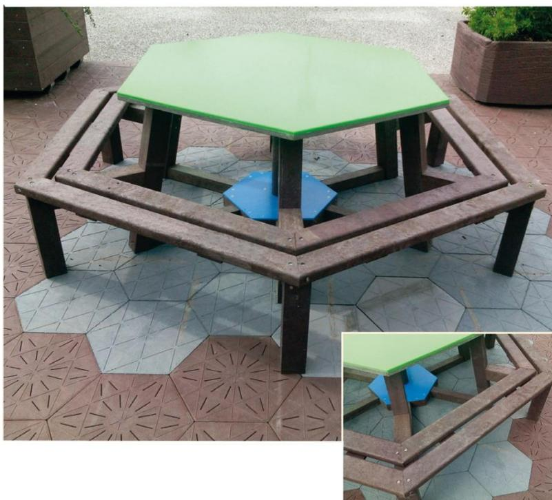
Tavolo panca interamente realizzato in plastica riciclata al 100% hanit® composto da N. 6 sedute collegate realizzate con n.2 profili di sezione rettangolare da 10,5 x 4,5 cm l'una di cui 6 rinforzati e 6 non rinforzati
